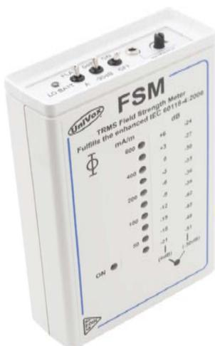
Medidor de intensidad de señal FSM: Instrumento para la medida profesional de sistemas inductivos de acuerdo a IEC 60118/4:2006.
