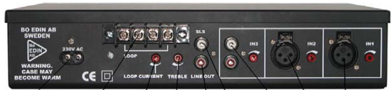
E.- conector de Alimentación F.- conectores de Bucle G.- Control de intensidad de Bucle H.- Control de Agudos I.- Salida de Línea J.- SLS K.- IN3 L.- IN2 M.- IN1
